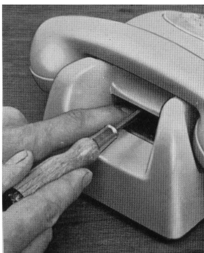
Fig. 6 Kåpan fästes med en skruv i bärfickan
