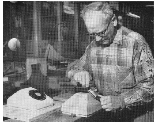
Fig. 16 Bearbetning av den träform, över vilken termoplasthöljet pressas
