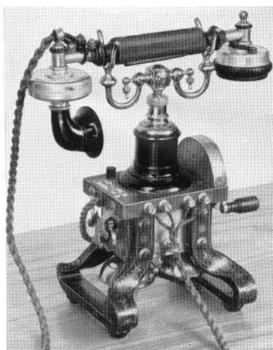
Fig. 7 L M Ericssons första bordapparat med handmikrotelefon, 1892 års modell
