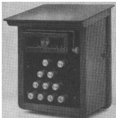
Fig. 4 Gruvväxel, Typ N 510 för 4 linjer
