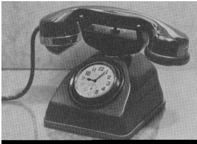
Fig. 1. CB apparat. Fingerskivan är ersatt med ett elektriskt ur.
