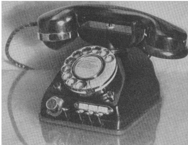
Fig. 3. Självväljareapparät. Tangenten till vänster är avsedd för inkoppling till huvudlinjen, de övriga tre tangenterna för lokallinjerna. Blänkaren indikerar om huvudlinjen är ledig. Knapparna äro avsedda för signalgivning och överföring av samtal till annan apparat
